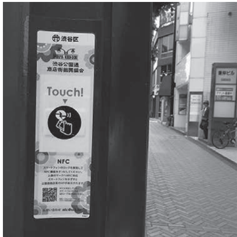
シブヤテレビジョンは、サイバーエージェント、凸版印刷、渋谷駅周辺の各商店街組合と共同で、渋谷駅周辺の街路灯に NFC 対応の IC タグ内蔵シールを設置し、NFC 搭載スマートフォンをかざすとお得な情報が取得できる「Shibuya Clickable Project (シブヤクリックابلプロジェクト)」を実施
