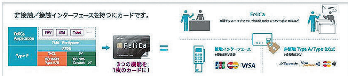
TypeA/TypeB方式およびクレジットカードの標準仕様であるEMV仕様(接触型および非接触型)をすべて1チップで対応可能な、多機能1チップソリューション
